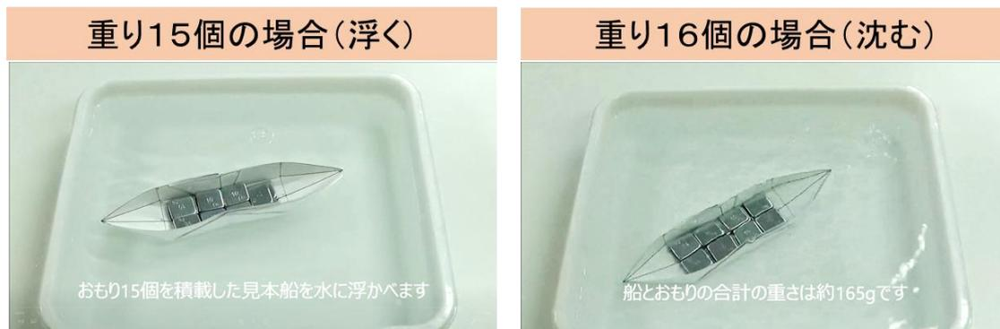
見本船の場合は重りを最大15個積載できることが分かりました。それでは「改良船」の場合は最大何個まで重りを積載することができるのでしょうか。右図は、改良船の制作の例を4つ取り上げたものです。折り方を変えるだけで様々な形状になっています。体積を求める際には、中央部分（直方体）と先端部分（四角錐）の辺をものさしで測定してから計算して下さい。中学3年生・高校生の皆さんは、ものさしで測定しなくても、三角形の合
