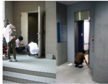
図 9-2 調査の様子 左)建物入口の段差の計測、データ登録の様子 右)エレベータの扉幅の計測、データ登録の様子
