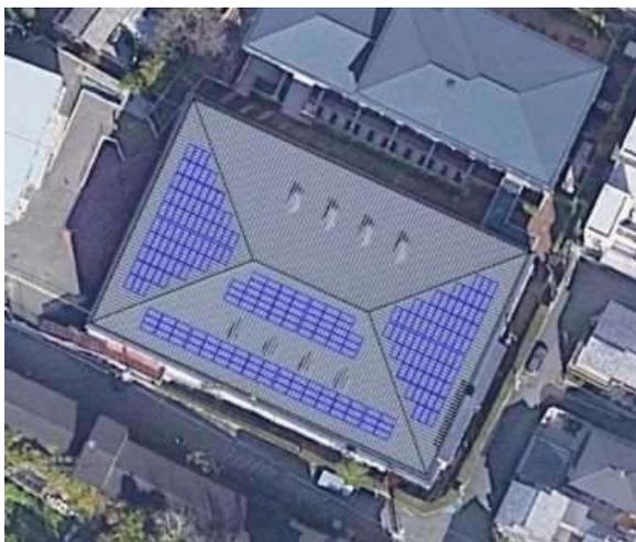
図1 CADに基づく太陽光導入ポテンシャルの特定
